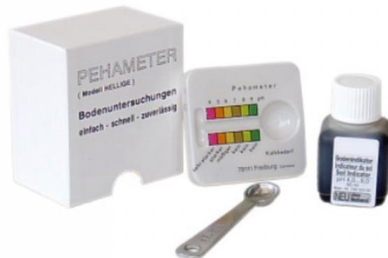
Anleitung: Eine kleine Menge Boden in die runde Vertiefung geben, mit dem Farbindikator überstauen und vermischen. Nach ca. 2 Minuten kann der Wert abgelesen werden. Dafür die Messplatte leicht kippen, sodass die Flüssigkeit über die Rinne fließt. Durch Vergleich der Farbe der Flüssigkeit mit der aufgedruckten Farbskala wird der pH-Wert abgelesen.
