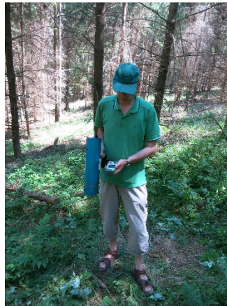
Abbildung 3: Messung der Umgebungsäquivalentdosisrate
