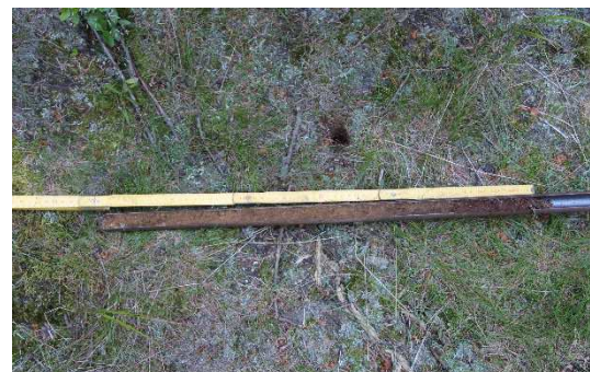
Abbildung 5: Stechbohrer für die Cäsium Tiefenverteilung
