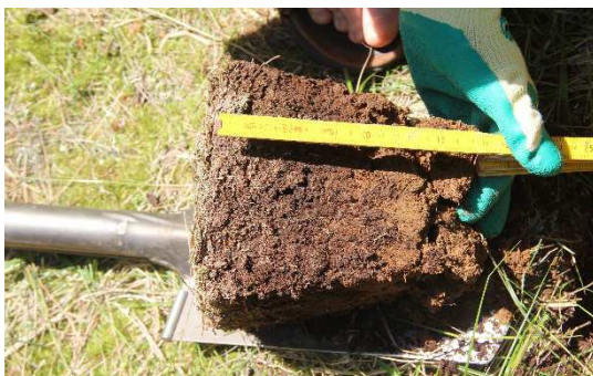
Abbildung 4: Spaten für Ah und B Horizontproben
